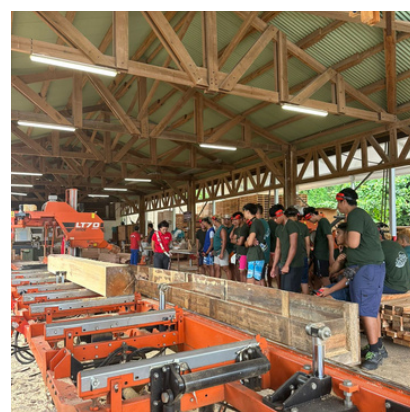
Démonstration du fonctionnement de la scie à ruban, outil essentiel de la scierie
